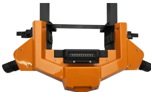
2. 拆除后头罩 10 颗 M3*8 螺丝。
