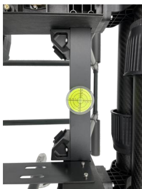
10、对机身进行水平校准，如果不平可调节机身水平，直到显示为居中。
