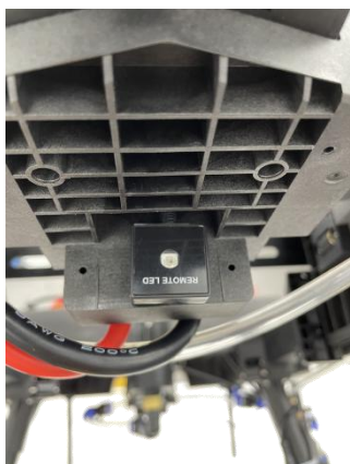
9、安装 LED 灯：使用 3M 胶将 LED 灯固定在机尾底部贴片位置。
