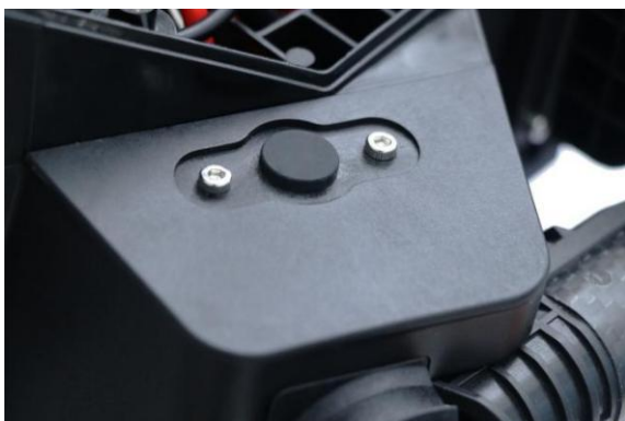
15、前机身两端留有 RTK 天线预留孔。
