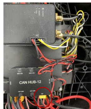
18、使用 3M 胶将 RTK 与雷达模块固定在飞控安装板上。
