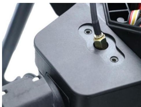
16、RTK 天线需穿过预留孔，到达飞控仓。
