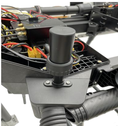
17、RTK 天线安装成品。
