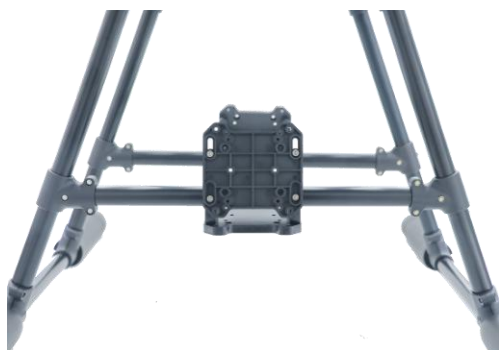
7、安装雷达固定板：将转接板安装在脚架斜撑上。
