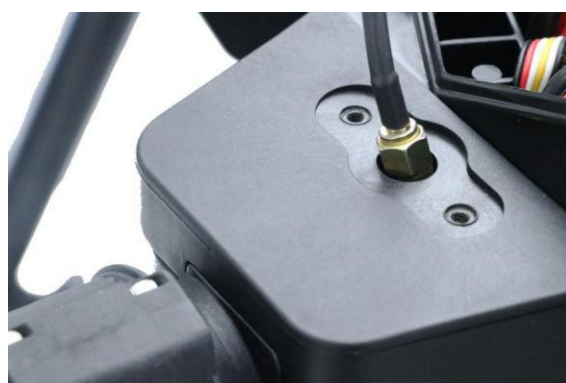
14、RTK 天线需穿过预留孔，到达飞控仓。
