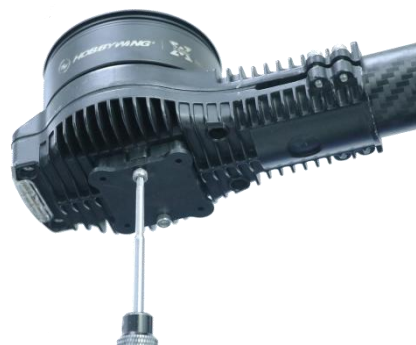
4、将 X6 转接件安装在机身上 使用 M3*8 螺丝进行固定
