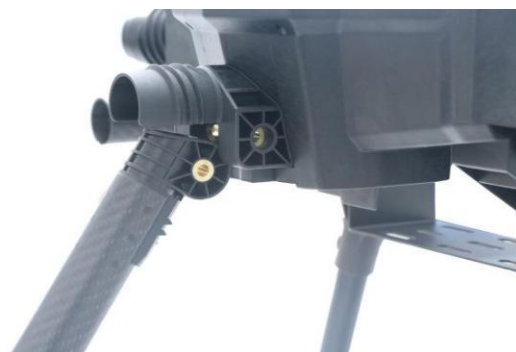
6、安装前后机臂组件；将前后碳管插入螺纹拆件中。
