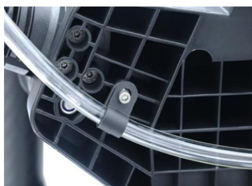
12、水泵安装；使用 M4*10 自攻螺丝固定水管管夹，水管需穿过管夹。
