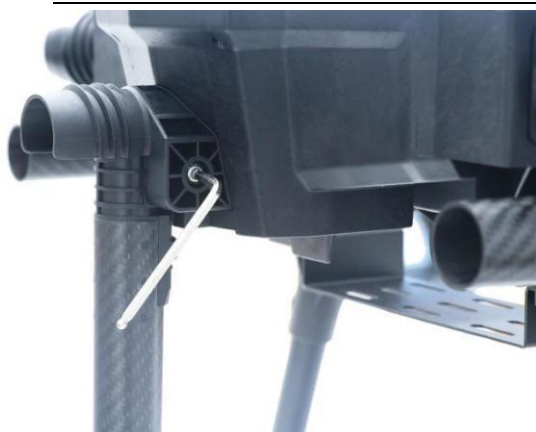
7、安装前后机臂组件；使用圆头 M6*50 螺丝对机臂进行固定。
