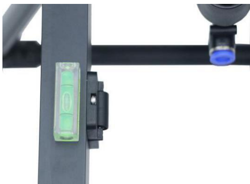
7、对机身进行水平校准，如果不平可调节机身水平，直到显示为居中。
