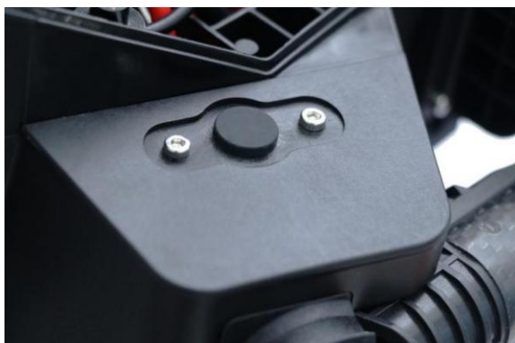
13、前机身两端留有 RTK 天线预留孔。
