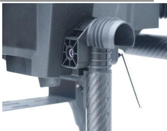
8、安装前后机臂组件；反面使用 M6 防松螺母进行固定。
