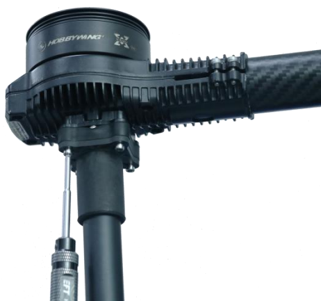
5、将喷头固定在 X6 转接件上，使用 M3*16 自攻丝进行固定
