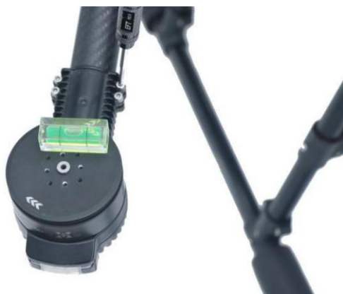
8、机身调节完毕后，将机臂完全展开，锁紧螺帽，进行电机水平校准，校准方法与机身校准相同。
