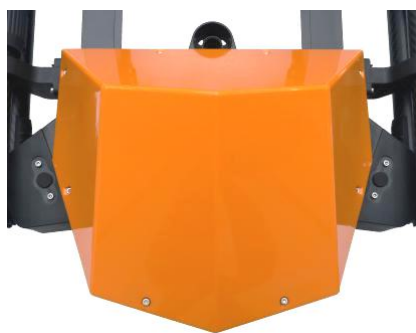
1. 拆除前头罩 8 颗 M3*8 螺丝。
