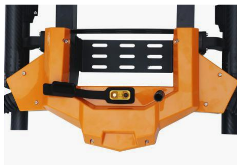
2. 拆除后头罩 10 颗 M3*8 螺丝。
