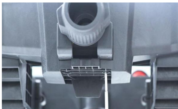
5、安装前后螺纹拆件组件；进行下方螺丝固定。
