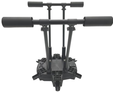
12、将脚架组件三通装到斜撑铝管上，注意三通的螺丝头全部位于飞机的外侧，螺丝暂时不用固定。
