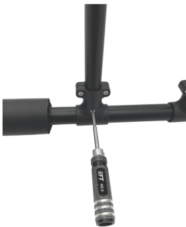
14、将 4 个脚架三通的 12 颗螺丝全部固定牢固。
