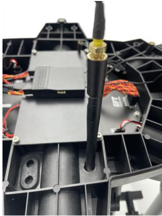
8、安装接收机：将接收机天线从圆孔中穿入。
