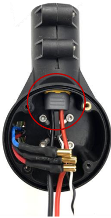
9、将电调的信号线和电源线从电机座穿入。
