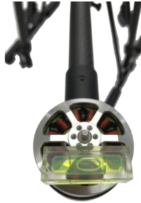
16、将电机座装进机臂碳管中，压到底，使用水平仪校准水平。
