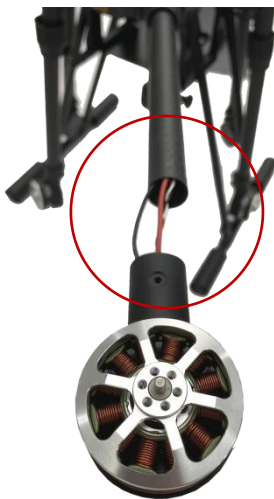
11、将电调的信号线和电源线穿入机臂碳管。
