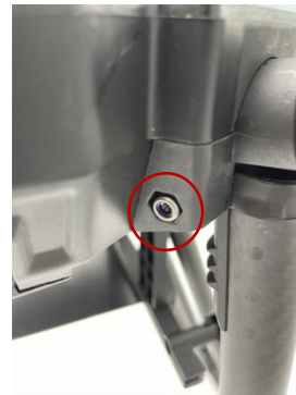
4、使用的为 M4 防松螺母，螺母从左边穿入，不带止松圈的一端塞到螺母孔的深处，带止松圈的一端在螺母孔的外侧。
