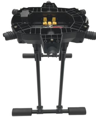
13、将飞机翻过来，脚架放在水平的地面上，斜撑铝管装到脚架三通的底部，调整一下脚架的左右位置，使脚架三通居中。
