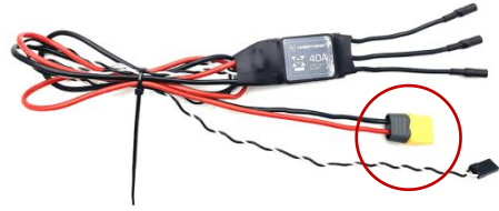
8、焊接 XT60H-M 插头，注意区分正负极。
