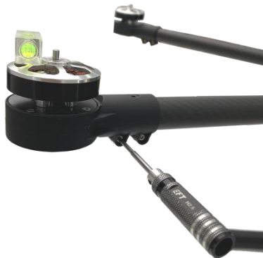
17、将固定电机座的两颗 M3*12 杯头螺丝固定牢固。
