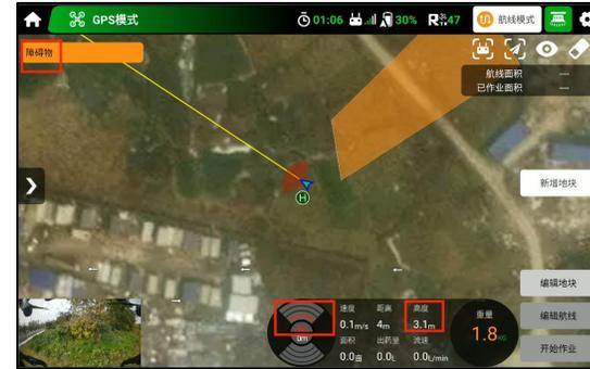
4、接收机信号测试：空旷区域测试遥控通讯距离通常大于1500m；
