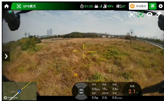
3、重量数据测试：在EFT农服APP主页面查看无人机在飞行过程中或者悬停状态下称重数据是否准确,无大幅度跳动；
