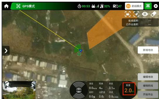
2、雷达数据测试：在EFT农服APP主页面雷达球内查看无人机在飞行过程中或者悬停下面对障碍物时前、后避障雷达探测的避障距离是否正常。以及仿地雷达探测的高度数据是否正常；
